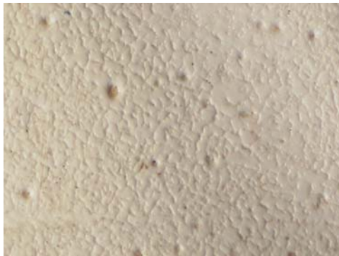
Oppervlakte van polyester laminaat 32x vergroot. Vertoont kraters in het gepigmenteerde oppervlak
