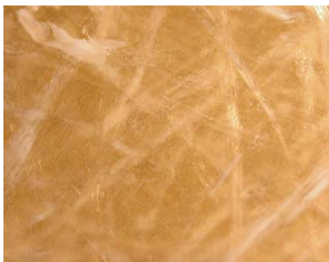
Oppervlak van een polyester laminaat met uitspringende glasvezel 32x vergroot
